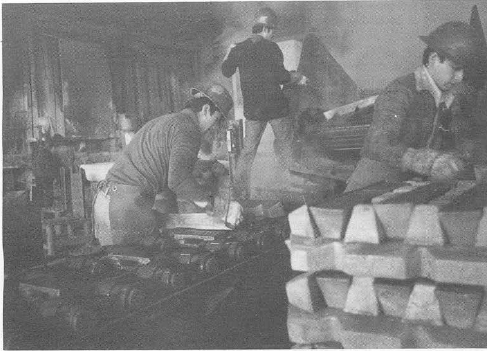
Le démoulage des lingots de cuivre dans la mine chilienne El Teniente.
